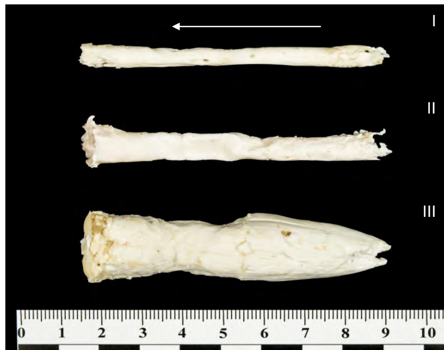
Рис. 4.13. Вид латексных слепков пулевых каналов (ОПП) в пластилиновых блоках, пораженных выстрелами из пневматической винтовки пулями I-III групп с расстояния 100 см. Стрелкой указано направление выстрелов.
