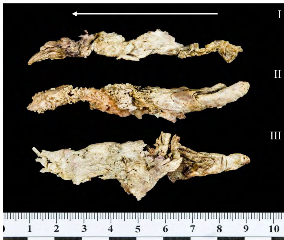
Рис. 5.8. Вид латексных слепков пулевых каналов в мышцах бедра биоманекена, пораженных выстрелами из пневматической винтовки пулями I-III групп с расстояния 100 см. Стрелкой указано направление выстрелов.
