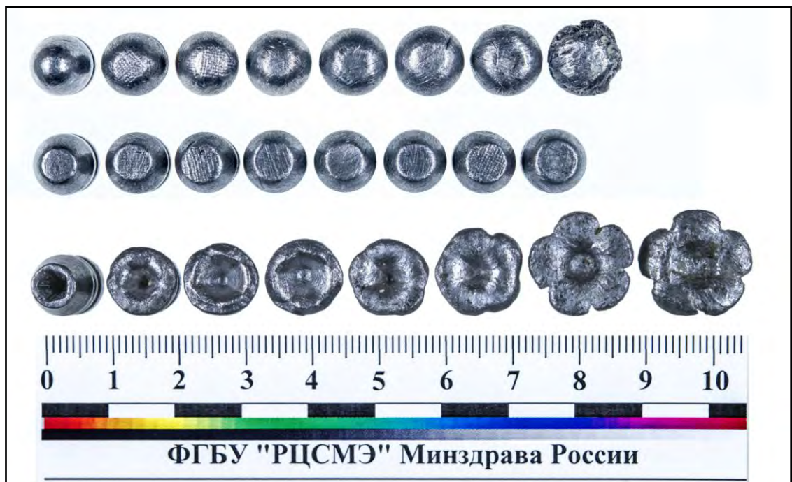
Рис. 3.2. Деформация 9,0-мм пуль I-III групп с различными формами их головных частей (I группа – верхний ряд, II группа – средний ряд и III группа – нижний ряд).
