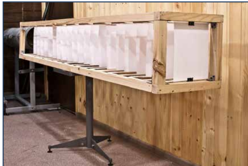
Рис. 2.4. Вид специального зажимного устройства (см. рис. 2.3) в каркасе (из скрепленных между собой деревянных брусьев) для комплекта мишеней (из 20-ти равноудаленных листов белой бумаги формата А4), размещенного по линии выстрела из арбалета в тире баллистической лаборатории ФГБУ "Российский центр судебно-медицинской экспертизы" Минздрава России.
