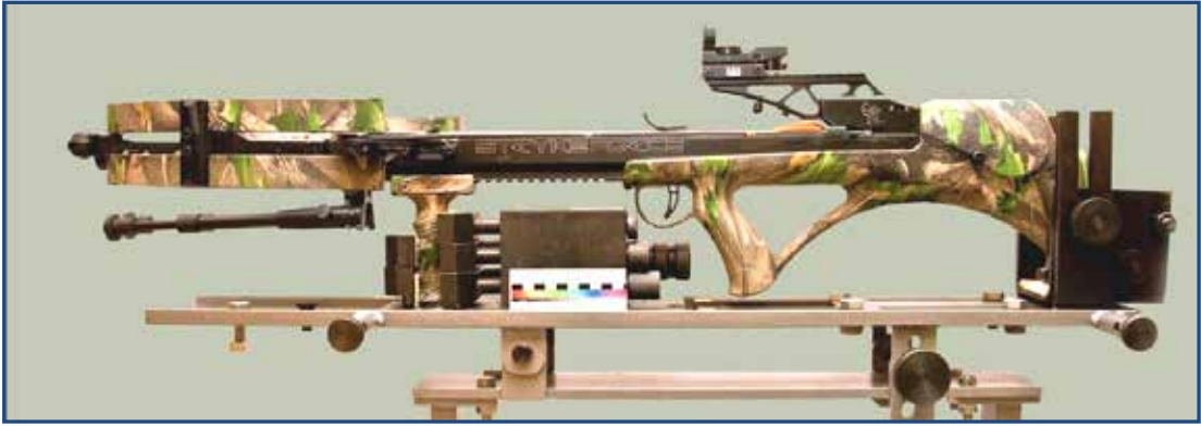
Рис. 2.1. Вид (сбоку) арбалета "Bowtech Strykeforce", закрепленного в зажимном устройстве специальной установки для экспериментальной стрельбы "Скорость" в тире баллистической лаборатории ФГБУ "Российский центр судебно-медицинской экспертизы" Минздрава России.
