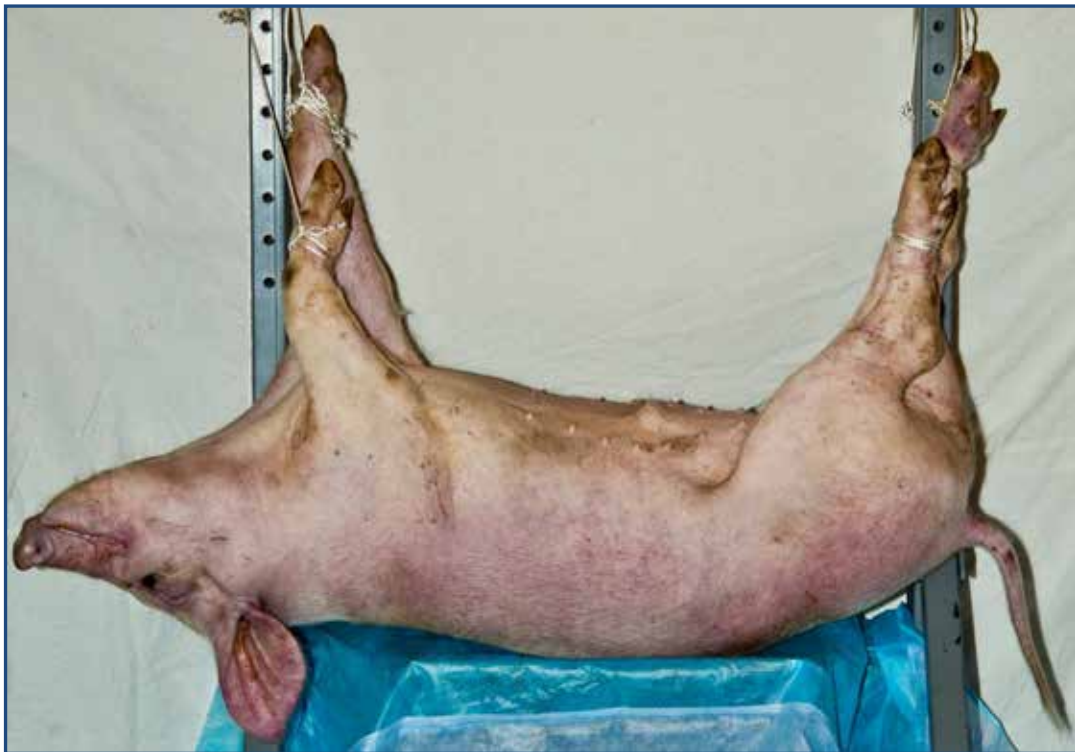
Рис. 2.5. Внешний вид биоманекена (трупа свиньи), закрепленного к держателям специального стенда установки "Скорость", перед началом экспериментальной работы.
