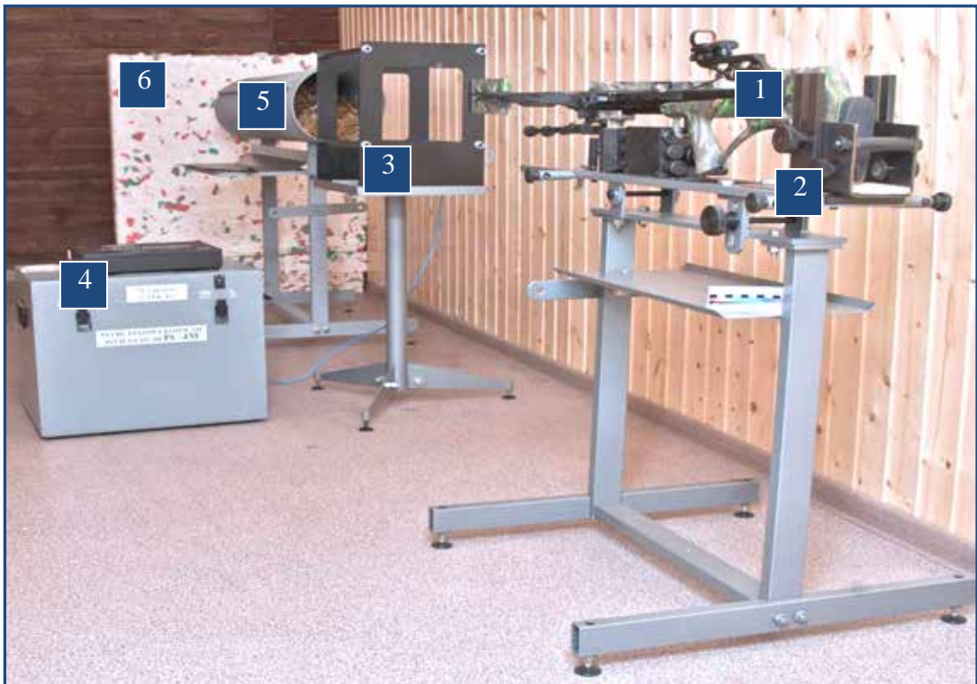
Рис. 2.2. Вид арбалета "Bowtech Strykeforce", закрепленного в установке "Скорость" на линии стрельбы в тире баллистической лаборатории ФГБУ "Российский центр судебно-медицинской экспертизы" Минздрава России. Обозначено: 1 – арбалет; 2 – зажимное устройство установки "Скорость"; 3 – рамка с датчиками прибора "РС-4М" (регистратора скорости полета стрелы), размещенная на подставке установки "Скорость"; 4 – прибор "РС-4М"; 5 – пулеулавливатель установки "Скорость", заполненный сверхвысокомодульным волокном ("СВМ"); 6 – блок изолон ("стрелулавливатель").
