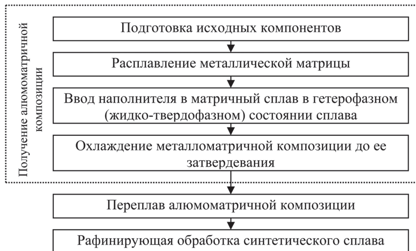
Рис. 1. Технологическая схема получения сплава системы Al-Si, синтезированного на основе алюмоматричной композиции
