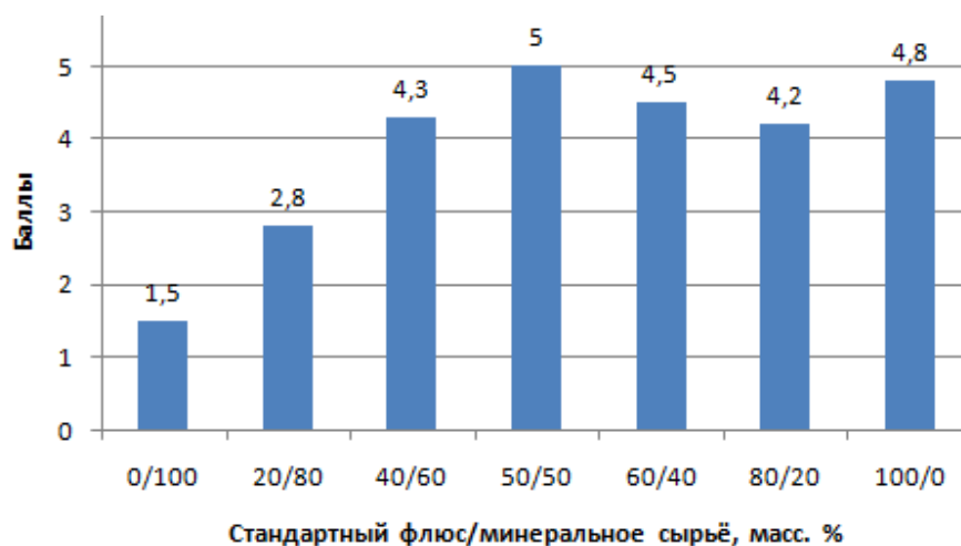
Рисунок 3.10 – Зависимость балла технологических свойств от соотношения компонентов шихты
