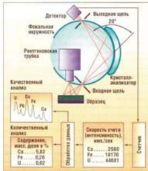
Рис. 1. Рентгенооптическая схема спектрометра «Спектроскан» [5]
