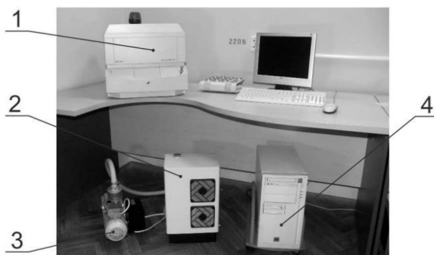
Рисунок 16 – Состав аппарата «СПЕКТРОСКАН МАКС-GV»: 1 – спектрометрический вакуумный блок, 2 – устройство водяного охлаждения, 3 – вакуумный насос, 4 – компьютер.
