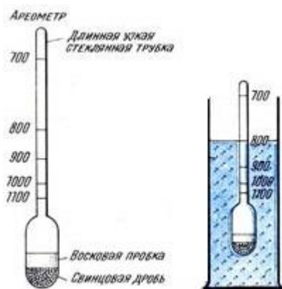
Рисунок 6 - Устройство ареометра.
