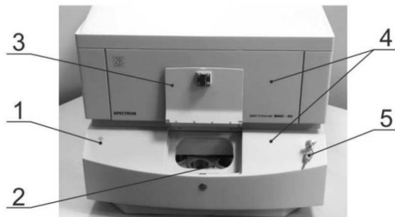
Рисунок 17 – Спектрометрический блок: 1 – световой индикатор включения сети, 2 – пробозагрузочное устройство, 3 – крышка, 4 – корпус, 5 – ключ для включения высокого напряжения.
